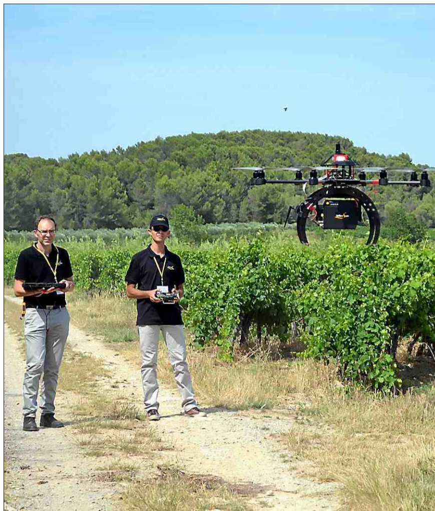
■ L'outil pèse à peine plus de 2 kg. Comptez 85 000 € pour le lidar et son drone. O.L.N.
